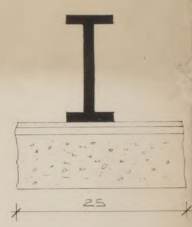
Sezione longitudinale Particolari: incastri nella muratura
